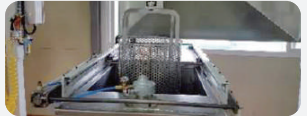
02. 딥앤스핀 고정 대량 또는 대형 제품 코팅에 적합한 자동화된 고효율·재료 절감형 전체 코팅 시스템
